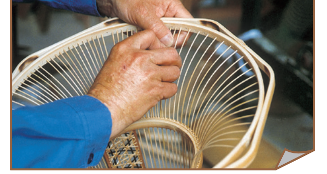
⑨組み立て（輪にあけた穴に「ひご」を通して組み立てます。）
