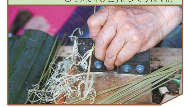
⑤ひご作り（細かく割った竹を鉄板の穴に通して丸い「ひご」をつくります。）
