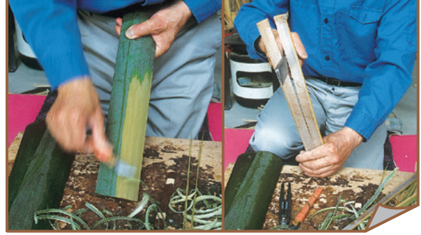
②材料作り（竹の皮は削り、「なた」で必要な寸法に割ります。）
