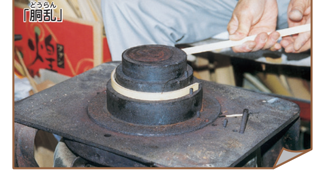
⑥輪作り（熱した胴乱に竹を巻きつけて「輪」をつくります。）
